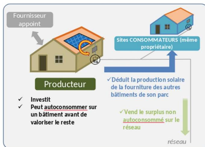
Figure 3 : schéma de fonctionnement d'une opération d'ACC patrimoniale simple (source AURA-EE)
